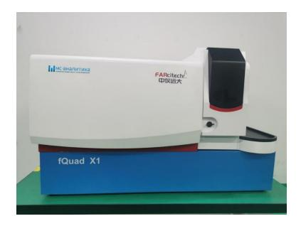
Квадрупольный масс-спектрометр Shaanxi Far-Citech серии fQuad X1 воплощает в себе наиболее современные технологии и обеспечивает высокочувствительный и точный, надежный и высокопроизводительный макро - и микроэлементный анализ наряду с изотопным скринингом.
